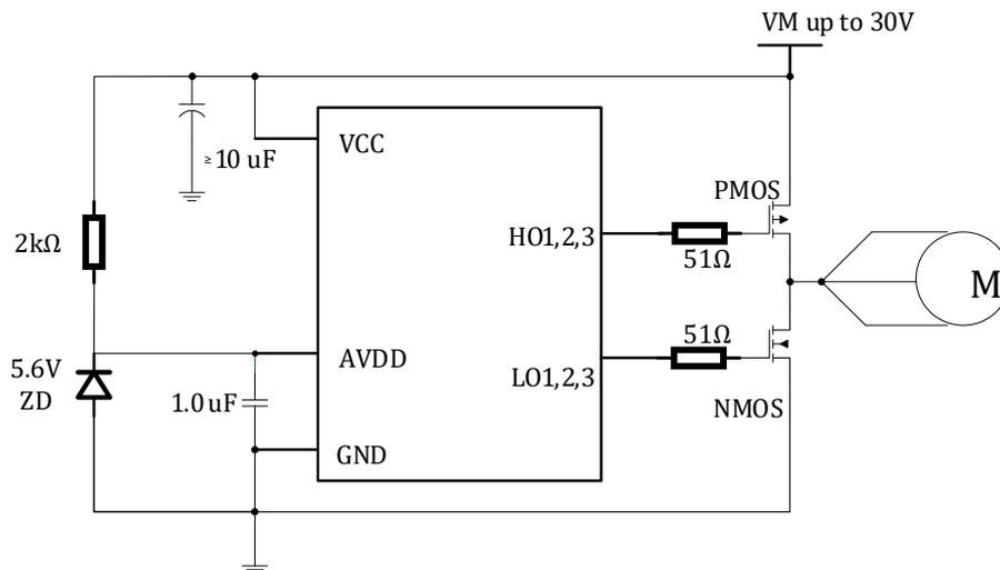
图 21-3 LKS32MC055DL6S8/ LKS32MC055EL6S8/LKS32MC057EM6S8 驱动模块典型应用图
