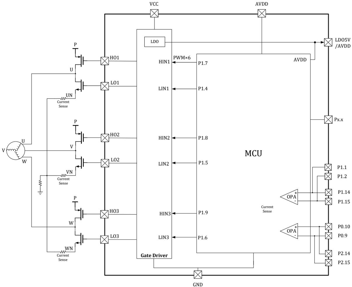
图 3-5 内部预驱连接示意图
