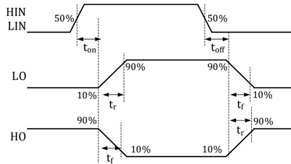
图 21-2 驱动模块输出变化沿时序波形
