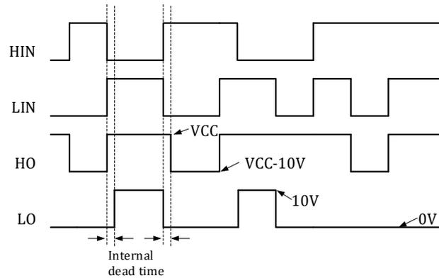
图 21-1 驱动模块输入输出时序波形
